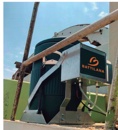
Sistema especializado de aplicación de inoculantes bacterianos.
